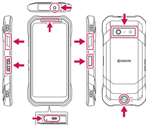
4 「水に濡れたときの水抜きについて」(→P.14)を参照して水抜きをする
