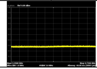
Client (UUT) no transmit on 802.11ac (VHT80) mode
