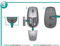
Español Coloque las pilas. (1) Pulse el botón para liberar el comparti-mento de las pilas. (2) Coloque 2 pilas AA. (3) Active el ratón.
