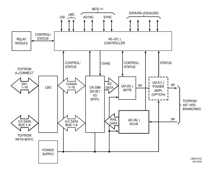
DS1/E1 Non-Standby System Functional Block Diagram
