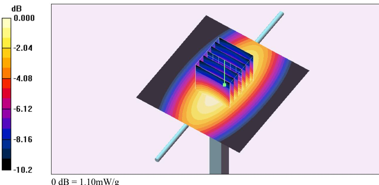
**System Check\_1900MHz\_091012****DUT: Dipole 1900 MHz**
