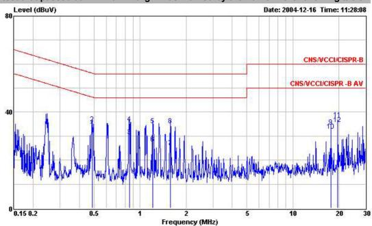
: CO01-HY : CNS/VCCI/CISPR-B 2003 2001/008 LINE : Router/AP product : 120V/60Hz : USR5451 and USR5461 : TC10A-050 Site Condition EUT Power Model Memo Memo
