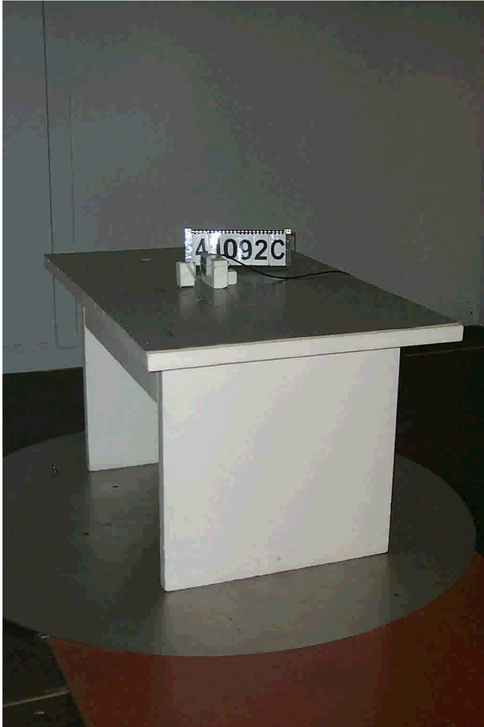
41092C_9.jpg KPD5 / SWH-4200, test set-up open area test site
