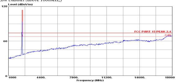
: RF Chamber : FCC PART 15 PEAK 2.4 Data no. : 1 Ant. pol. : HORIZONTAL Limit
