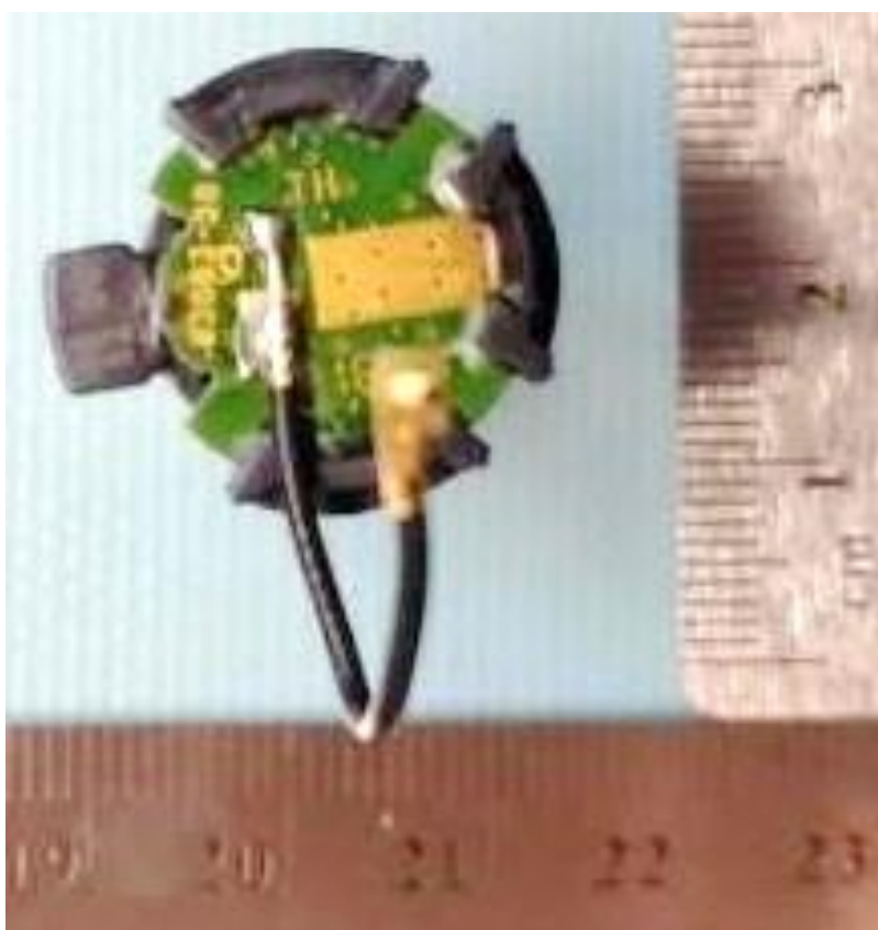
GNSS antenna bottom
