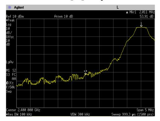
Low CH\_Zigbee\_Band Edge
