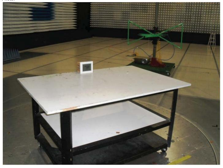
Test Setup (30-1000MHz)
