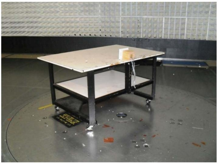
Test Setup (30-1000MHz)
