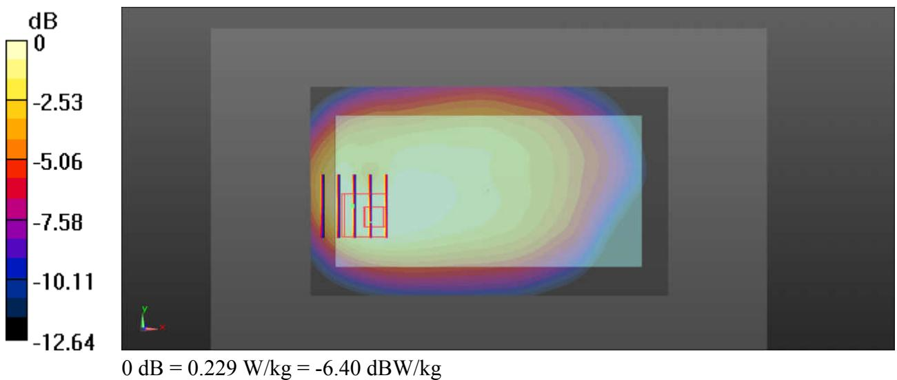
**34\_LTE Band 5\_10M\_QPSK\_1RB\_25Offset\_Back\_10mm\_Ch20525**
