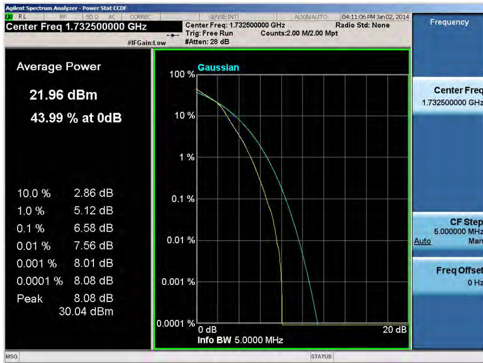
Plot 9-42. PAR Plot (5.0MHz 16-QAM – RB Size 25)
