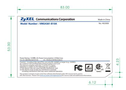
註: 1.材質及表面處理:消銀龍。 2.顏色:藍色部分印刷顏色為PANTONE 287 C,其餘為PANTONE Process Black C。 3.背膠:一般膠。 4.儲存溫度:
