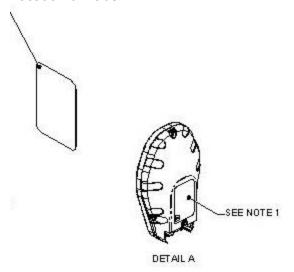
NOTE: 1. LABEL TO BE CENTERED ON THE FLAT SURFACE ON THE REAR OF CONTROLLER.
