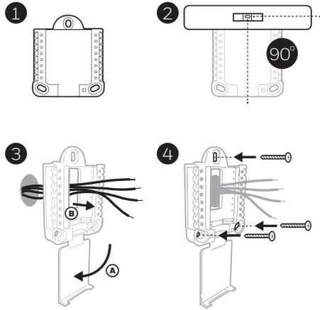
Use los 3 tornillos que se proporcionan (N.º 8 de 1-1/2 [38 mm] para los taquetes rojos y N.º 6 de 1-1/2 [38 mm] para los taquetes amarillos)
