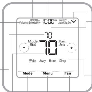
La pantalla se activará al presionar el área central de la temperatura que se muestra. La pantalla permanecerá encendida durante 45 segundos. El brillo se puede ajustar desde el menú.
