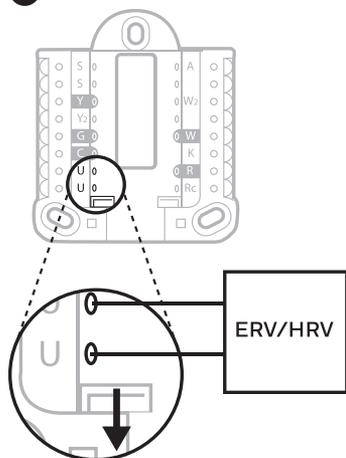
Con conexión al regulador de aire fresco alimentado por el transformador del equipo de calefacción.
