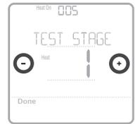
**REMARQUE :** L'horloge sert de minuterie lorsque les étages fonctionnent. Les indicateurs de marche du chauffage et du refroidissement sont affichés lorsque le test du système est en cours.
