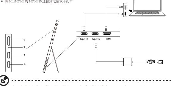
擴展顯示器時,請確保您的設備(移動/PC)是具有支持視頻輸出(DP ALT)的 Type-C 端口。
