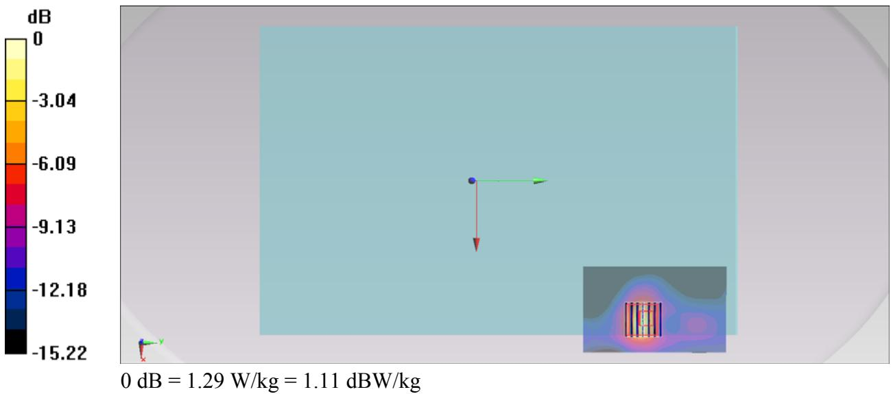
**#194\_WLAN5GHz\_802.11a 6Mbps\_Bottom Face\_0cm\_Ch120;Ant 1**
