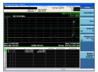
$\pi$  /4-DQPSK: Band Edge-Low Channel (Hopping Mode)
