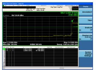
$\pi$  /4-DQPSK: Band Edge-High Channel
