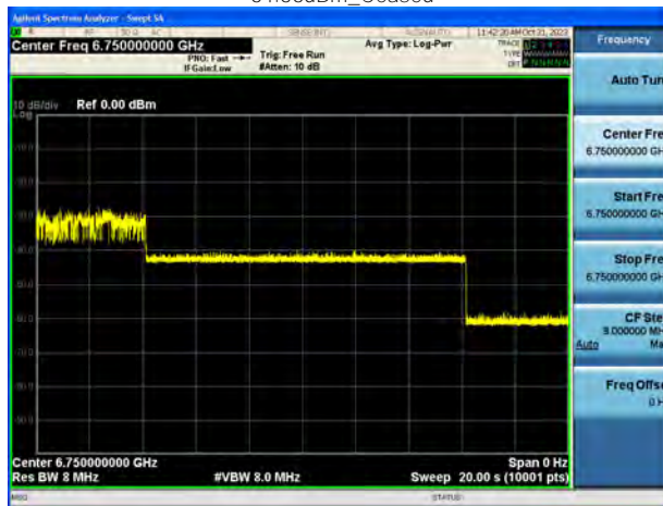
802.11be_320MHz_CF 6905MHz_Interference_6750MHz_-73.66dBm_Mini- mal
