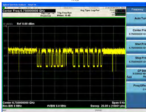
802.11be_320MHz_CF 6905MHz_Interference_6750MHz_-76.66dBm_Nor- mal
