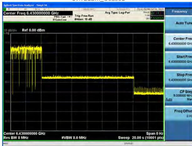
802.11be_320MHz_CF 6585MHz_Interference_6430MHz_-75.72dBm_Mini- mal
