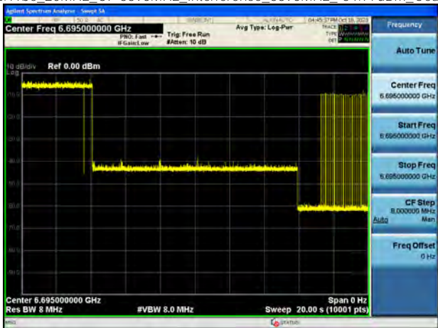
802.11be_20MHz_CF 6695MHz_Interference_6695MHz_-71.77dBm_Minimal 802.11be_20MHz_CF 7015MHz_Interference_7015MHz_-72.77dBm_Minimal
