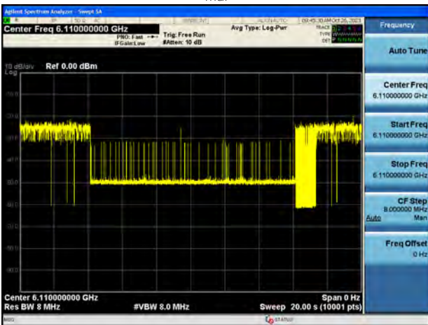
802.11be_320MHz_CF 6265MHz_Interference_6110MHz_-78.04dBm_Nor- mal
