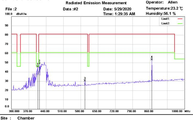
Condition : FCC 15.231(433MHz) 300-1000(PK) EUT : W6M22003-19782 M/N: Test Mode : TX 433.82MHz Note :
