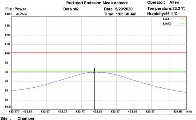
Condition : FCC 15.231(433MHz)Power(PK) EUT : W6M22003-19782 M/N: Test Mode : TX 433.82MHz Note :
