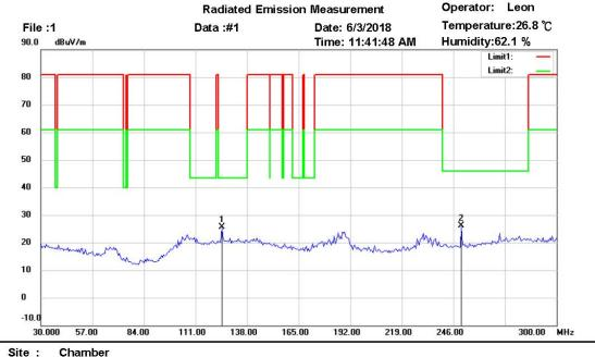
Condition : FCC 15.231(433MHz) 30-300(PK) EUT : W6R21805-18133 M/N: Test Mode : TX 433.82MHz Note :
