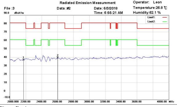
Site : Chamber Condition : FCC 15.231(433MHz) 2000-4000(PK) EUT : W6R21805-18133 M/N: Test Mode : TX 433.82MHz Note :
