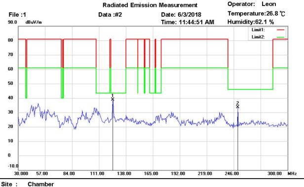
Site : Chamber Condition : FCC 15.231(433MHz) 30-300(PK) EUT : W6R21805-18133 M/N: Test Mode : TX 433.82MHz Note :
