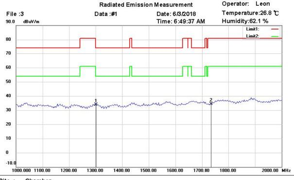
Site : Chamber Condition : FCC 15.231(433MHz) 1000-2000(PK) EUT : W6R21805-18133 M/N: Test Mode : TX 433.82MHz Note :
