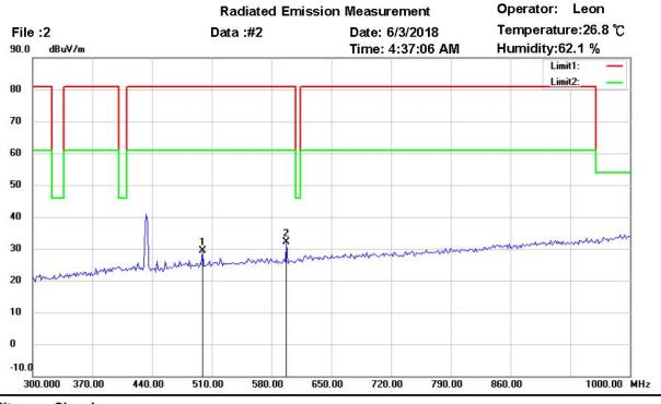
Site : Chamber Condition : FCC 15.231(433MHz) 300-1000(PK) EUT : W6R21805-18133 M/N: Test Mode : TX 433.82MHz Note :
