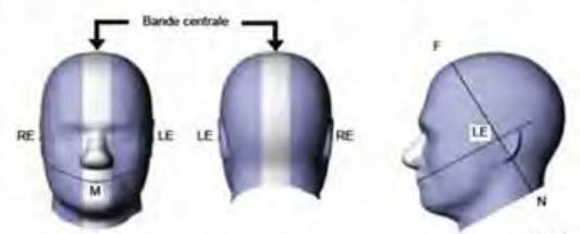
Illustration du fantôme donnant les points de référence des oreilles, RE et LE, le point de référence de la bouche, M, la ligne de référence M-F et la bande centrale
