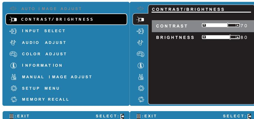
Appuyez sur le bouton **Menu/Exit (Menu/Quitter)** en bas à droite de votre VSD243 pour lancer l'écran de configuration OSD. L'écran de configuration OSD peut être utilisé pour configurer le Contraste / la Luminosité, la Sélection d'entrée, le Réglage audio, la Colorimétrie, les Informations, le Réglage manuel de l'image, le Menu de configuration et le Rappel mémoire.
