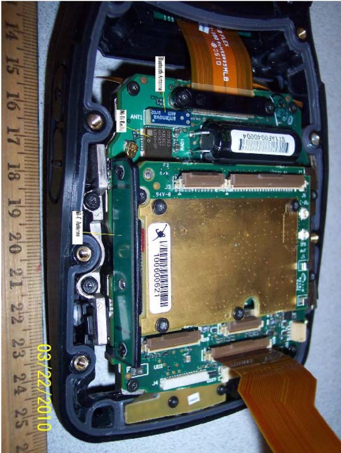
BT Antenna_WIFI Radio_WIFI Antenna
