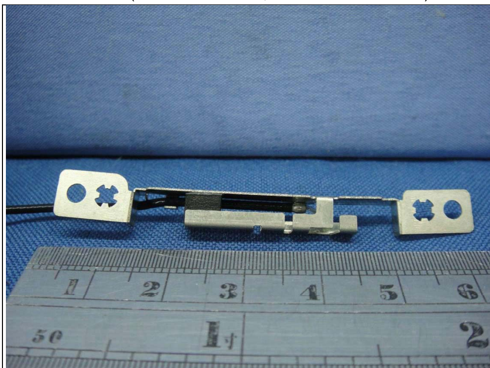
Antenna (Aux / Brand: WNC, Model: 81.ED415.001)
