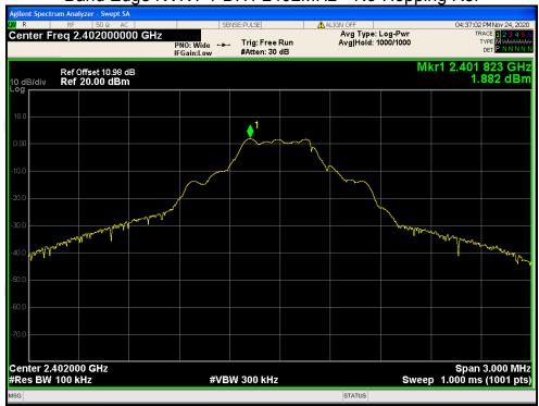
Band Edge NVNT 1-DH1 2402MHz No-Hopping Emission
