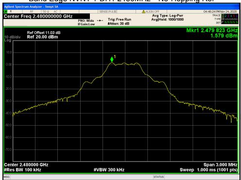
Band Edge NVNT 1-DH1 2480MHz No-Hopping Emission
