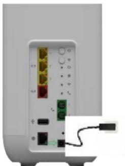
Branchez le connecteur de l'adaptateur secteur sur le port d'entrée d'alimentation de votre passerelle Ethernet. Branchez l'adaptateur sur une prise de courant à proximité.
