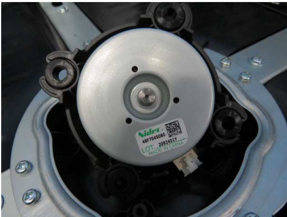
Fan motor view
