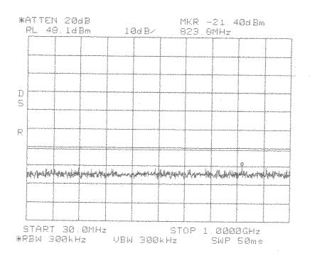
Intermodulation Apart TDMA PCS 1900 MHz BEF Band
