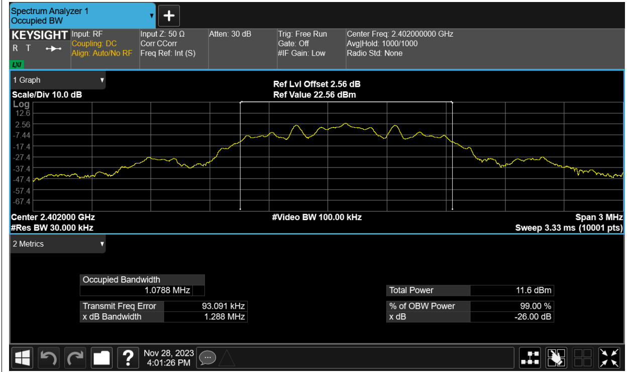
OBW NVNT BLE 2442MHz Ant1
