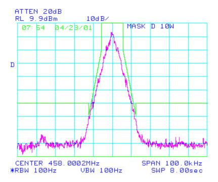
MASK: D, 8K17F1D, 50W SPECTRUM FOR EMISSION **8K17F1D** OUTPUT POWER: 50 Watts
