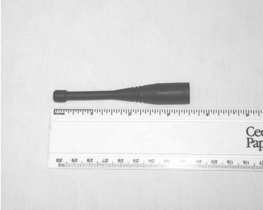
Intermec 5055 local ant. PN 805-544-00X 2dBi dipole FCC ID: EHACLMC350
