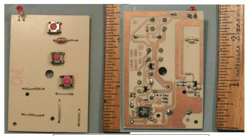
PCB PHOTO, SMT COMPONENTS ON BACK SIDE, THRU HOLE COMPONENTS ON TOP SIDE. SMALL JUMPER ON U1 IS TO ENABLE CONTINUOUS TRANSMIT.
