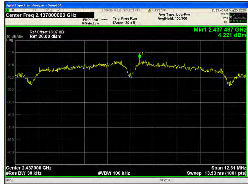
PSD NVNT b 2437MHz Ant1
