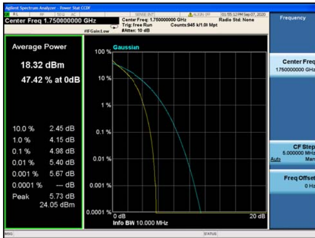
Band 4 / 10MHz / High CH / QPSK
