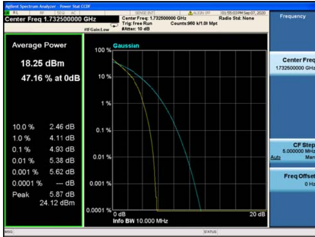
Band 4 / 10MHz / High CH / QPSK
