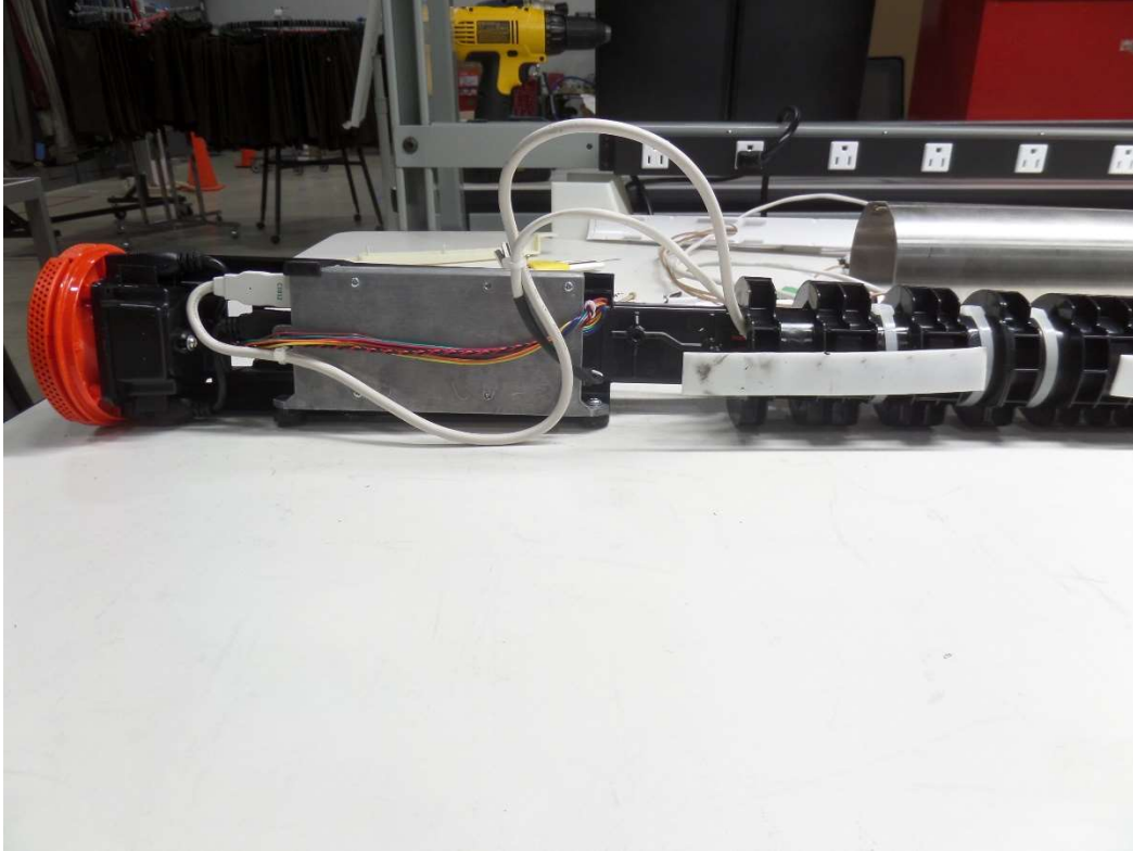
Figure 7: NS40 antenna top section showing SOM module
