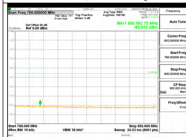
LTE B14 5MHz 16QAM Low Channel FRB.gif
