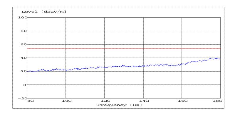
ANALYZER SETTINGS: f < 1 GHz: RBW/VBW: 100 kHz f³ 1GHz: RBW/VBW: 1 MHz
