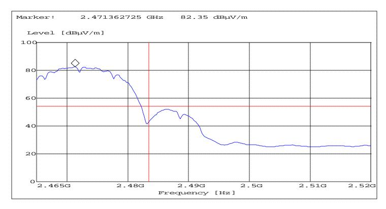
ANALYZER SETTINGS: RBW=1MHz VBW=10Hz
