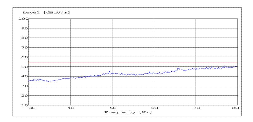
ANALYZER SETTINGS: f < 1 GHz: RBW/VBW: 100 kHz f 3 1GHz: RBW/VBW: 1 MHz
