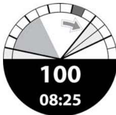
Compresión excesivamente superficial: se muestra una flecha.
