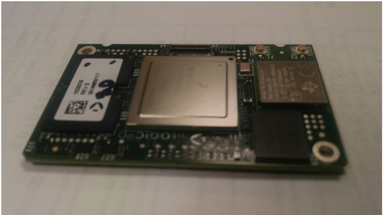
Side view of the Top of the TI WL1837 SOM board
