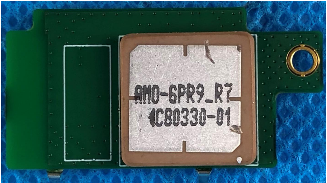
656-25989-000 PCB, GPS- SPTM1(Version S) -Front
