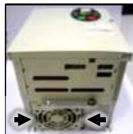
Fan assembly removal
