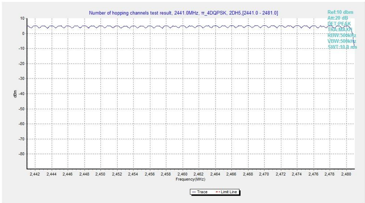
Fig. 78 Hopping channel ch40 ~ ch78 ( \pi /4 DQPSK)
