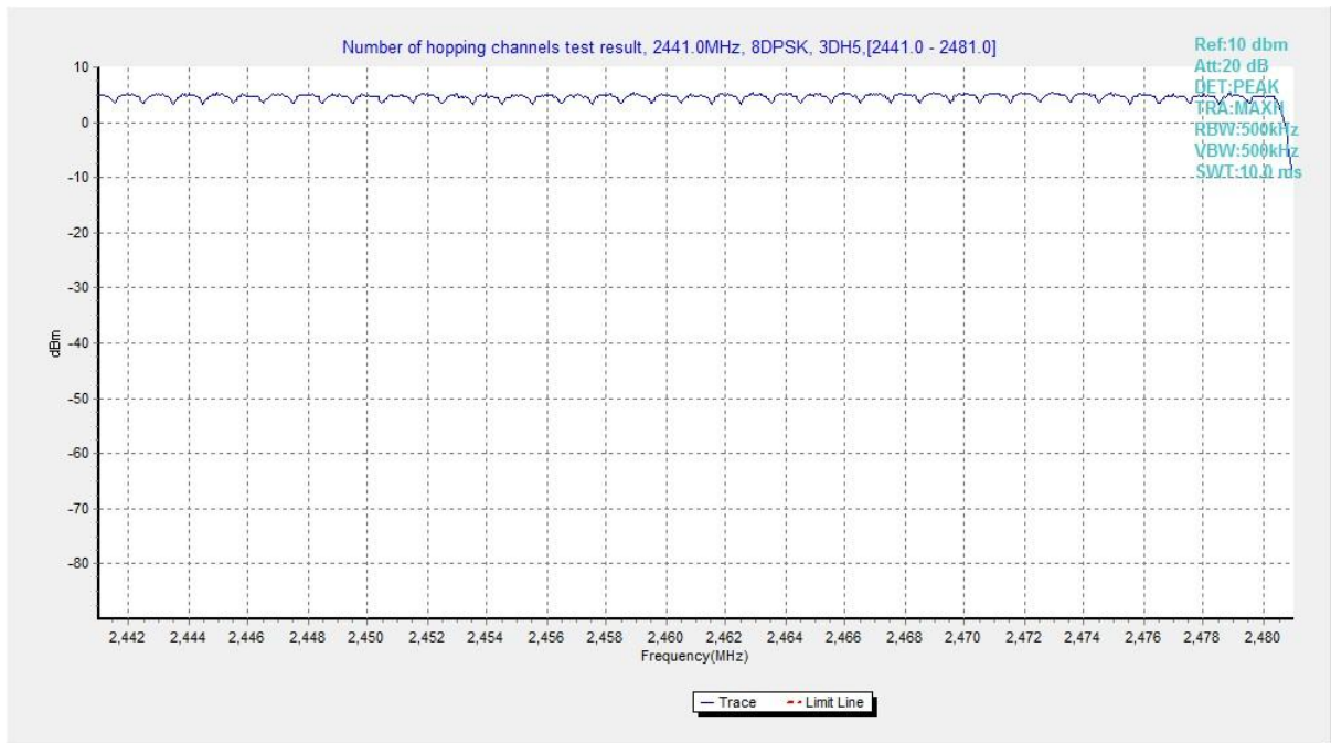
Fig. 80 Hopping channel ch40 ~ ch78 (8DPSK)
