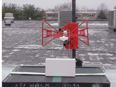
HONEYWELL OATS SITE: SENSE HORZ, UUT VERT:
