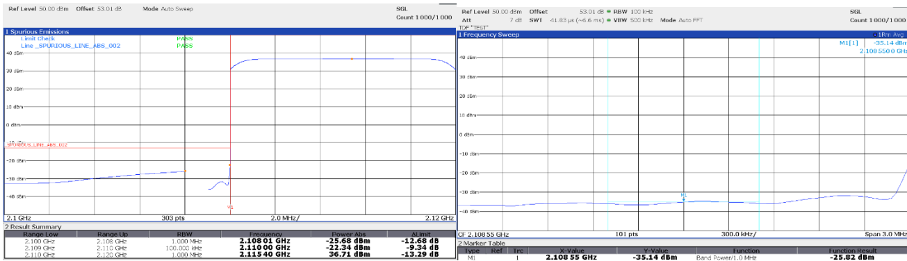
Band Edge. TX:2115MHz, BW: 10MHz, MOD: QPSK
