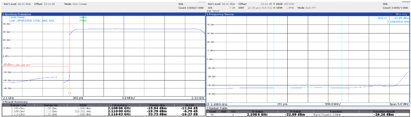
Band Edge. TX:2120MHz, BW: 20MHz, MOD: 64QAM
