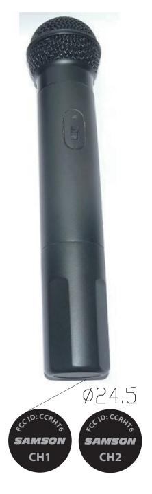
1. FCC ID LABEL STUCK ON THE BOTTOM OF THE HOUSING
