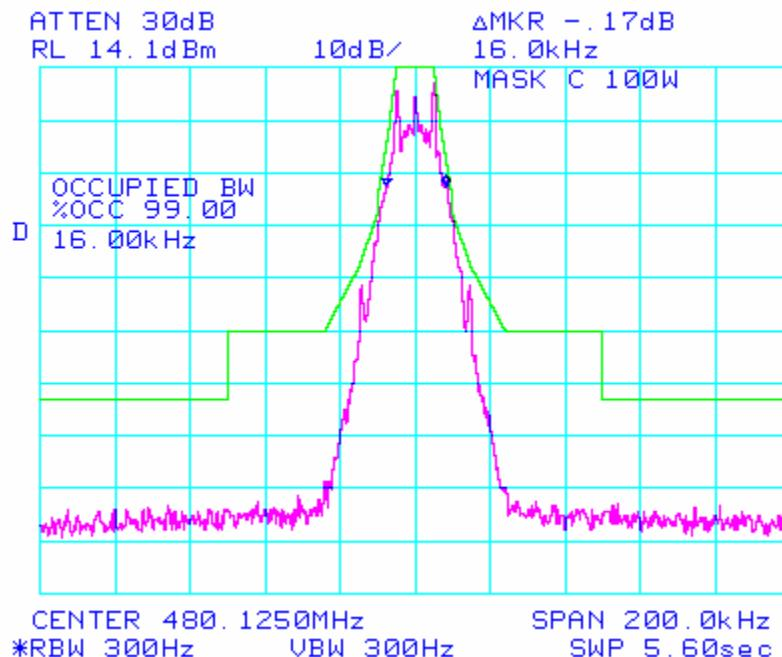
SPECTRUM FOR EMISSION **15K7F1D**, 19200bps, DGMSK BT factor=0.3
